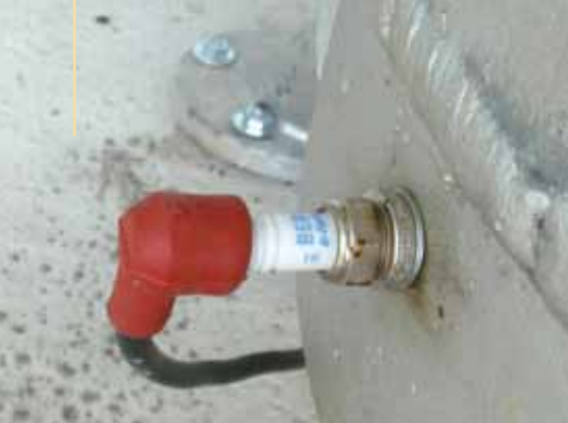
Fot. 6. Świeca zapłonowa zainstalowana w dolnej części komory zapłonowej
